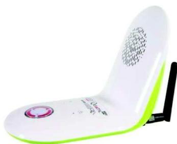
Le Quiatil Easy GSM/GPRS se raccorde uniquement sur prise électrique, plus besoin de ligne RTC.
