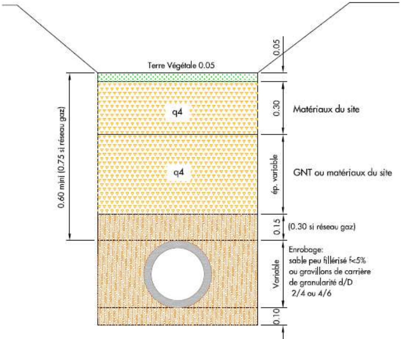
Les matériaux de remblaiement: Matériaux du site avec  $D < 40\text{mm}$
