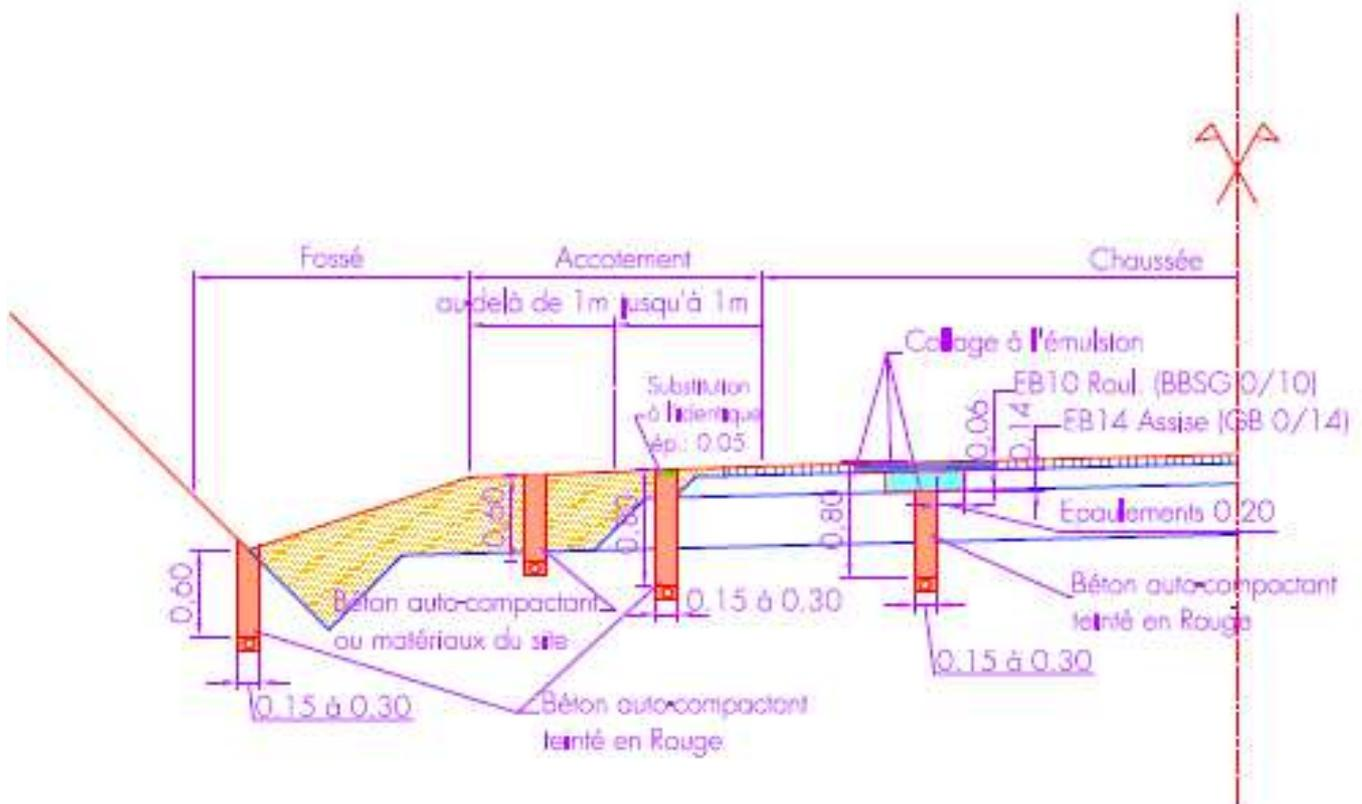
Les résistances à la compression des matériaux auto-compactants devront satisfaire les conditions suivantes:  $1.5 \text{ MPa} < R_{c28} < 4 \text{ MPa}$ .
