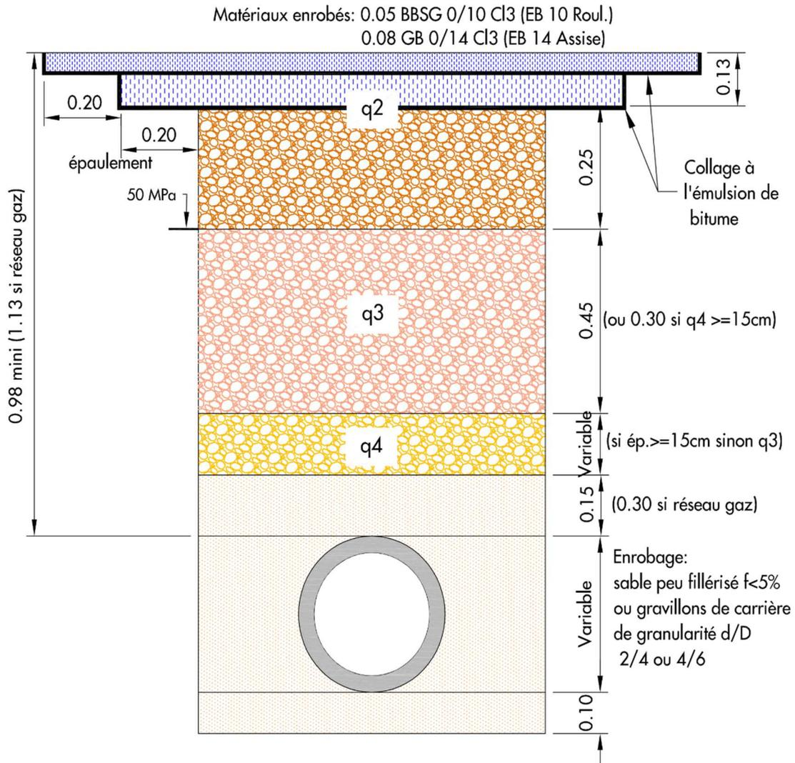
Les matériaux de remblaiement (GNT 0/31.5 ou 0/20) seront de code Cb au sens de la norme NFP 18-545. L'usage de matériaux alternatifs est possible en partie q4 uniquement.
