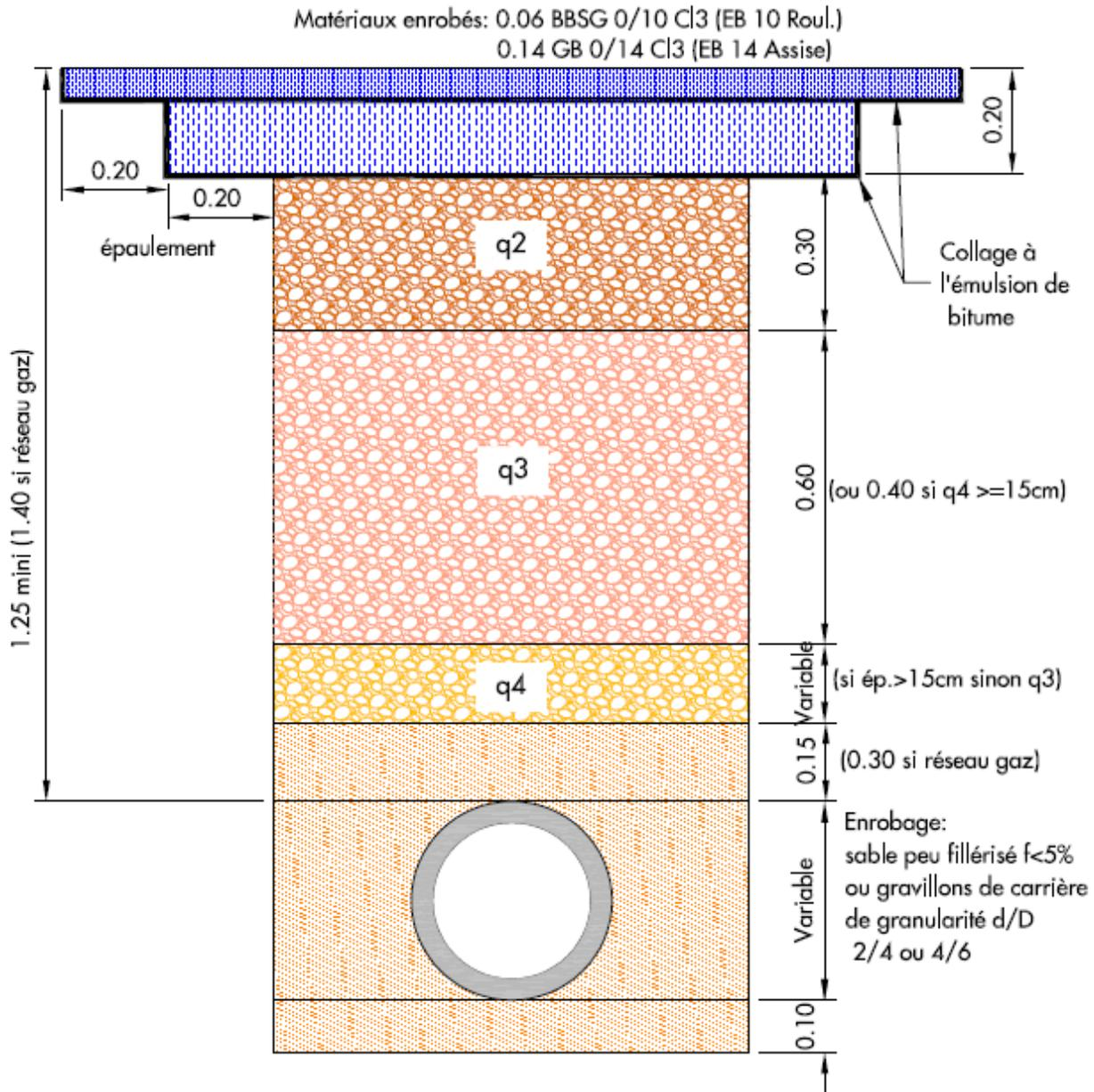
Les matériaux de remblaiement (GNT 0/31.5 ou 0/20) seront de code Cb au sens de la norme NFP 18-545.
