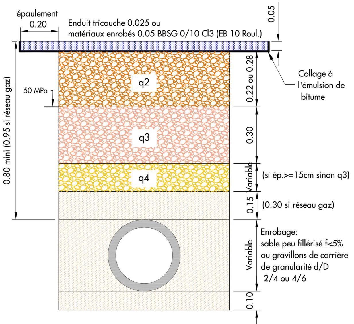
Les matériaux de remblaiement (GNT 0/31.5 ou 0/20) seront de code Cb au sens de la norme NFP 18-545. L'usage de matériaux alternatifs est possible en parties q3 et q4 uniquement.
