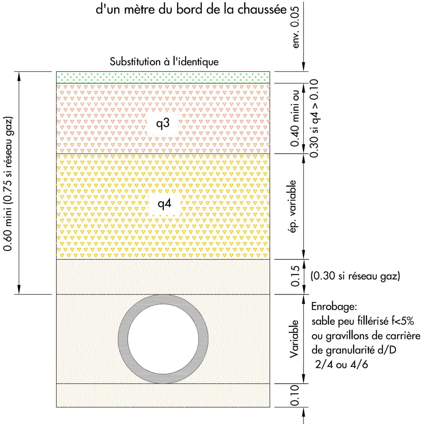
Les matériaux de remblaiement : matériaux du site avec  $D < 40$  MM
