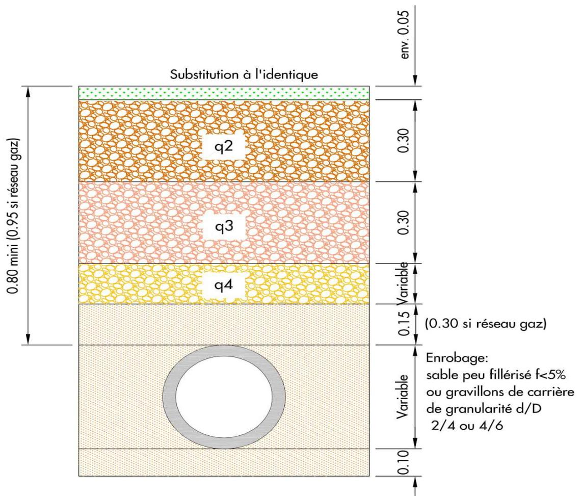
Les matériaux de remblaiement (GNT 0/31.5 ou 0/20) seront de code Cb au sens de la norme NFP 18-545.
