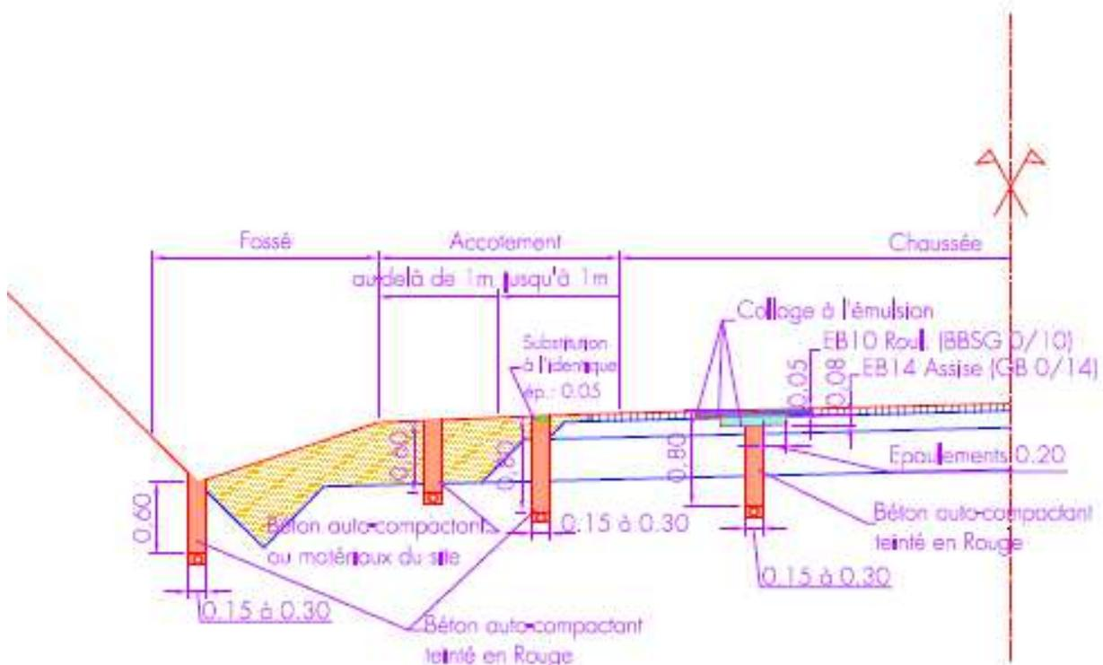
Les résistances à la compression des matériaux auto-compactants devront satisfaire les conditions suivantes:  $1.5 \text{ MPa} < R_{c28} < 4 \text{ MPa}$ .
