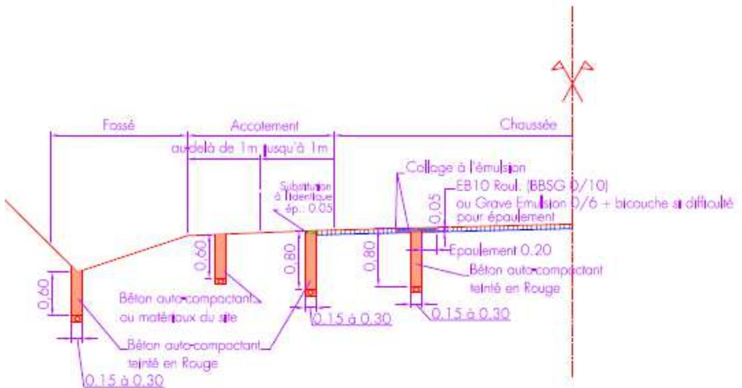
Les résistances à la compression des matériaux auto-compactants devront satisfaire les conditions suivantes:  $0.7 \text{ MPa} < R_{c28} < 2 \text{ MPa}$ .
