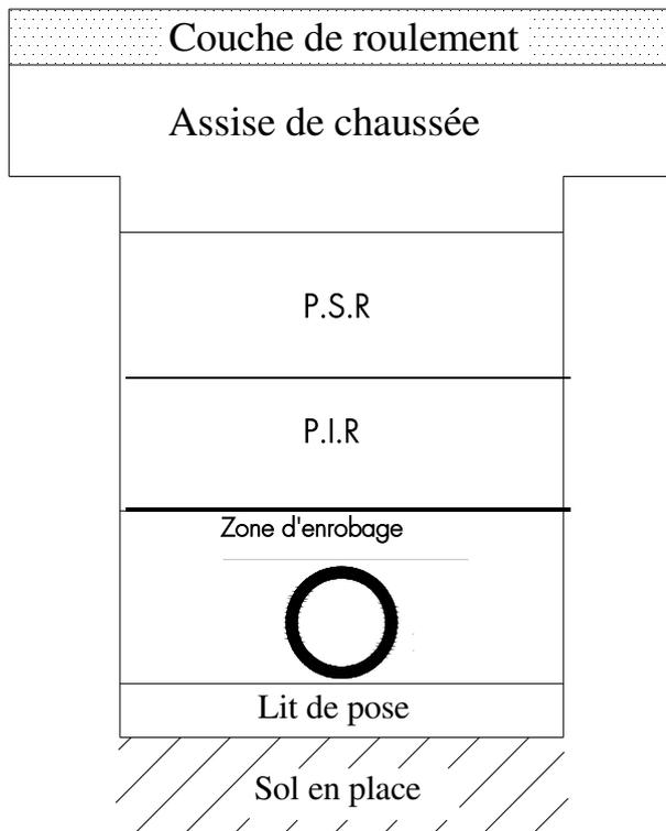
*RAPPEL : les largeurs minimales des tranchées qui sont fonction de leurs profondeurs, du type de blindage employé et du diamètre extérieur de la canalisation ou du câble, sont définies dans le chapitre V.6.3 du fascicule 70 du CCTG "Ouvrages d'assainissement".*
