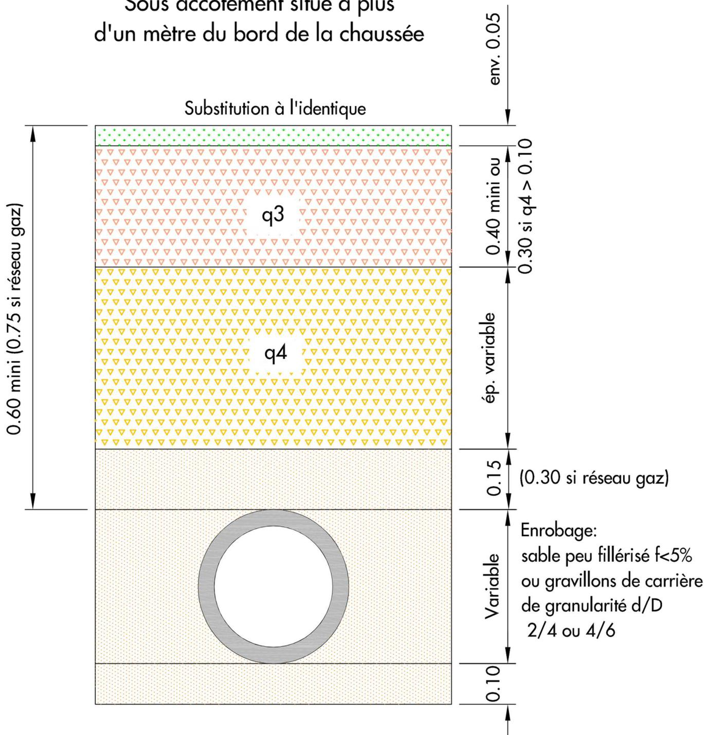
Les matériaux de remblaiement : matériaux du site avec  $D < 40$  MM
