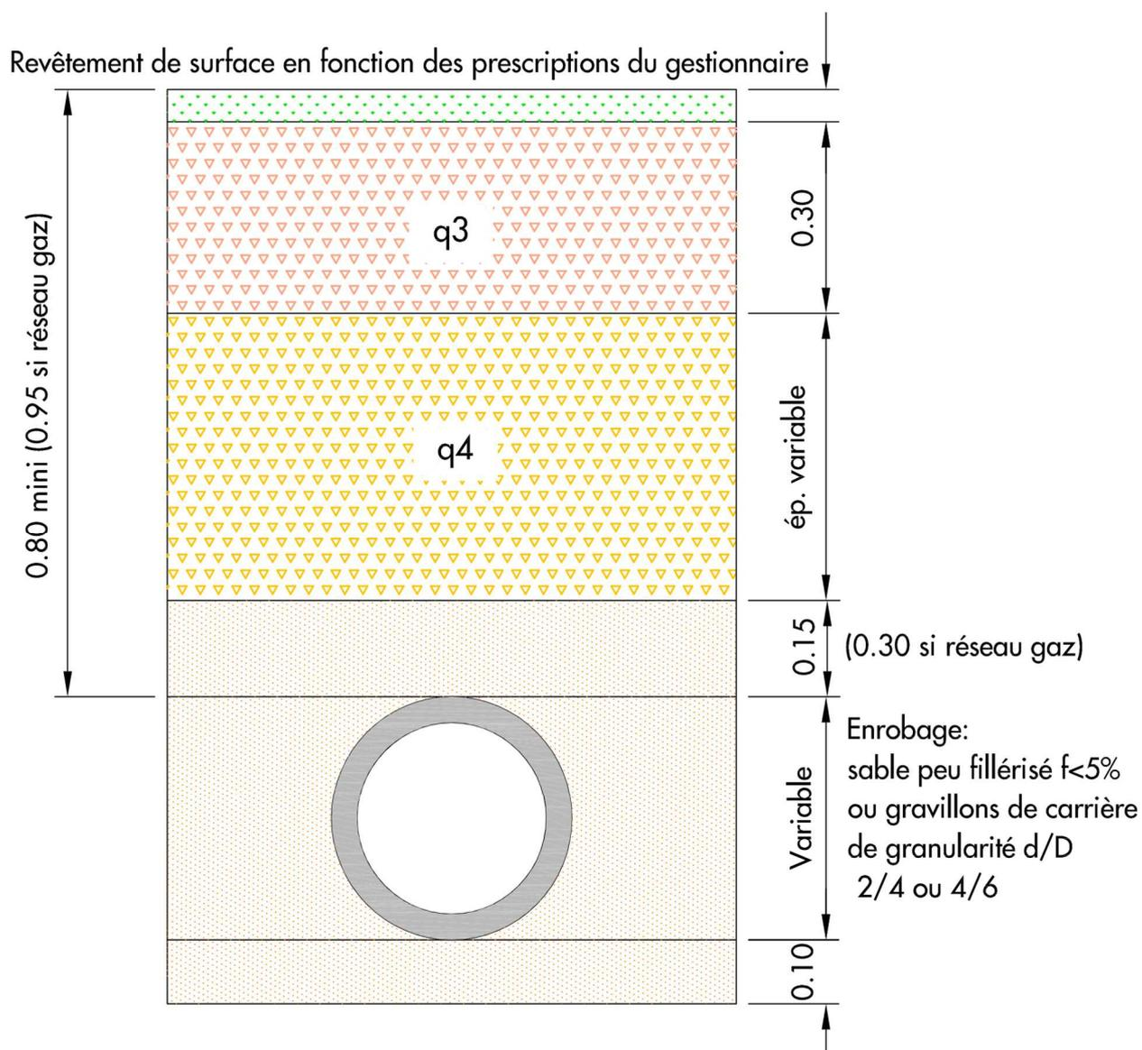
Les matériaux de remblaiement (GNT 0/31.5 ou 0/20) seront de code Cb au sens de la norme NFP 18-545.
