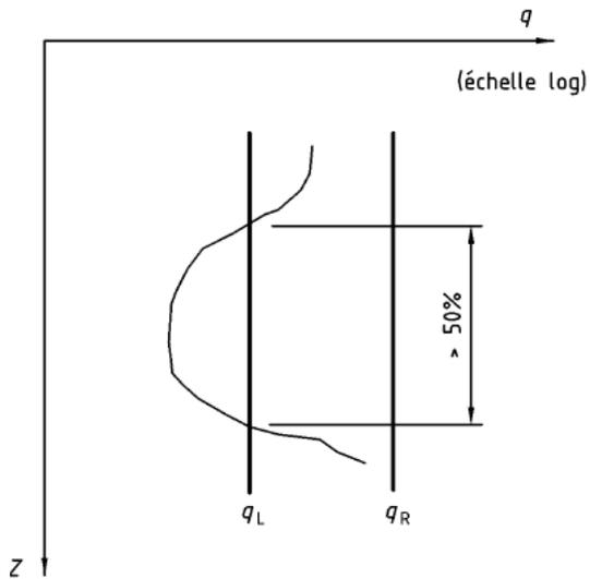
⊖ Le pénétrogramme dépasse  $D_L$  sur plus de 50% de la hauteur testée "h".
