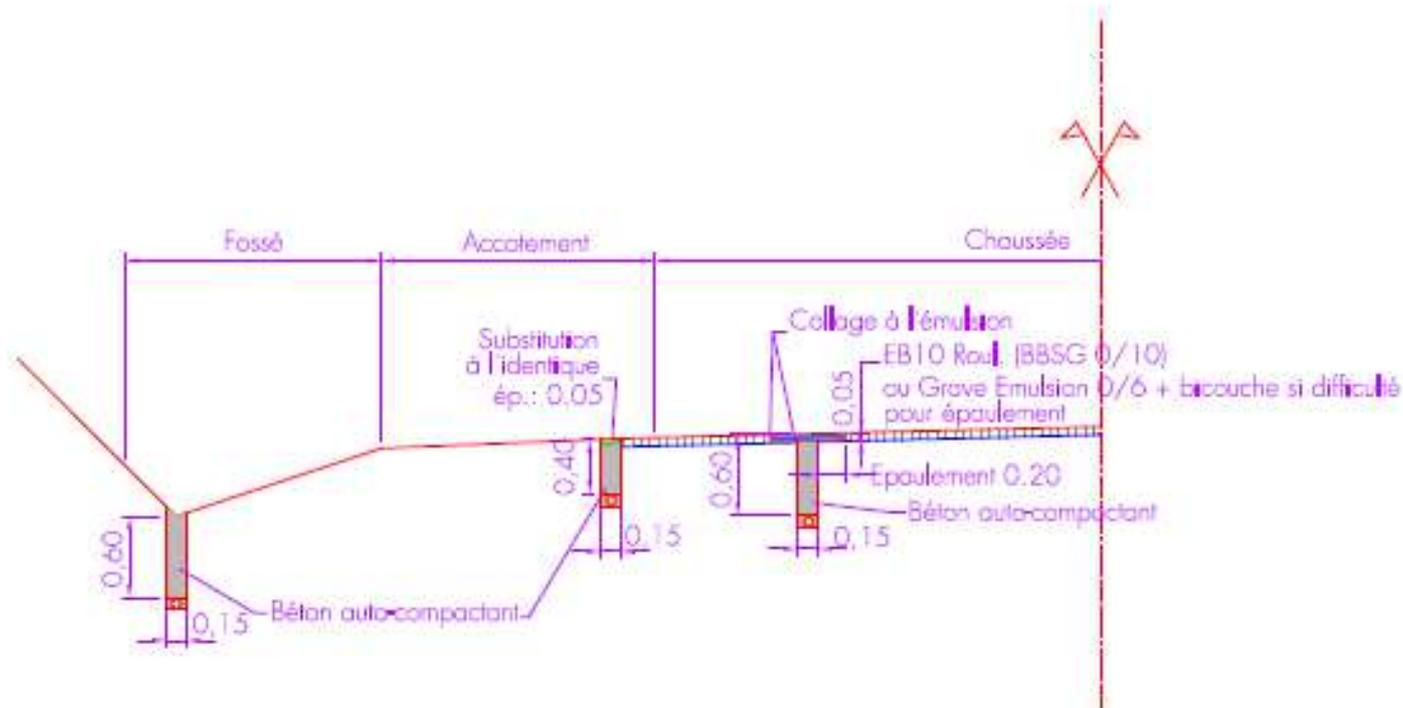
Les résistances à la compression des matériaux auto-compactants devront satisfaire les conditions suivantes:  $0.7 \text{ MPa} < R_{c28} < 2 \text{ MPa}$ .
