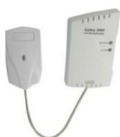
Il détermine la concentration de monoxyde de carbone qui passe souvent inaperçu car inodore, déclenche une sonnerie et envoie une alarme sur la plateforme d'écoute.
